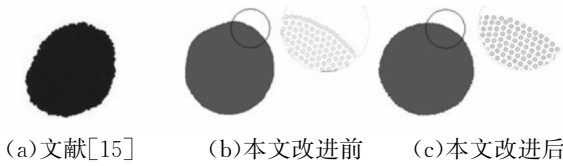
图 2 3 种算法稳态圆形液滴的数值模拟结果
